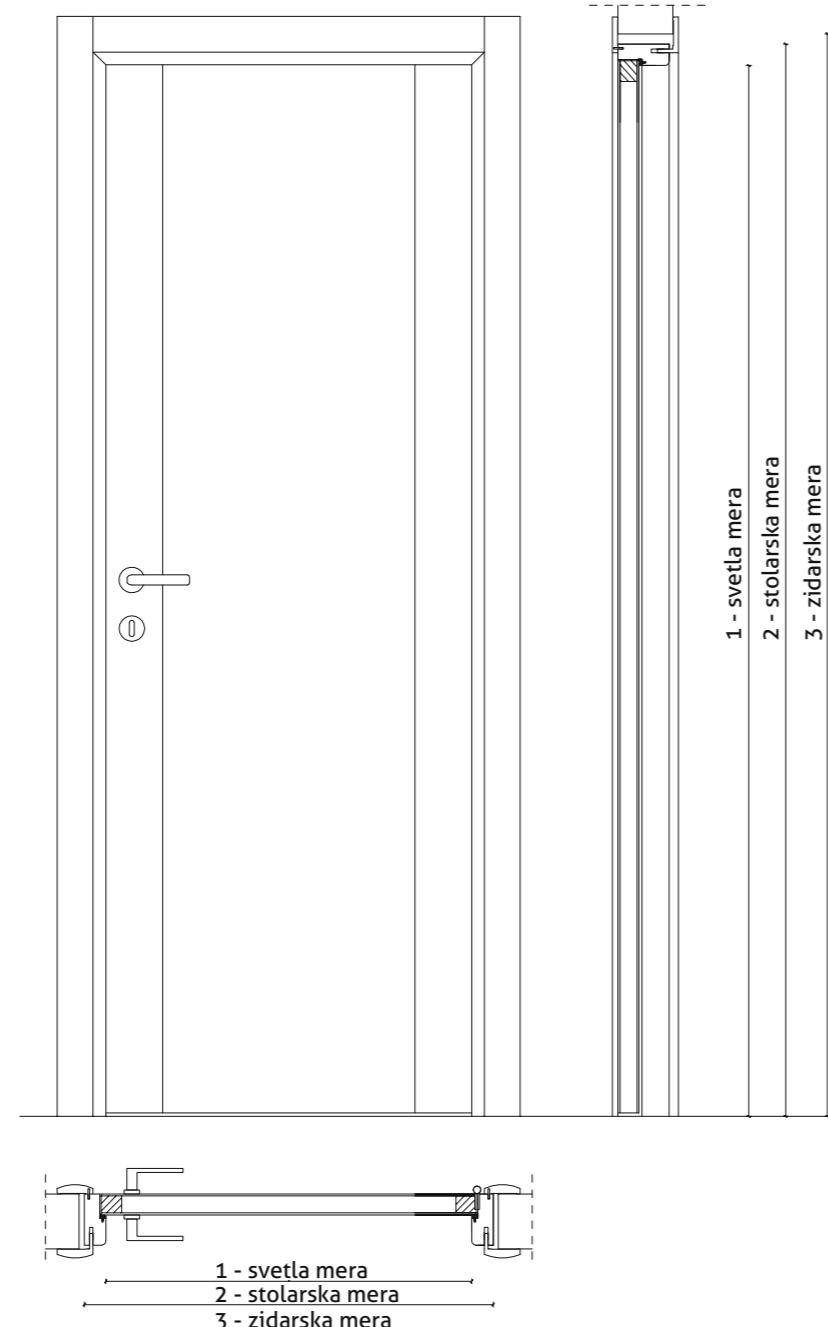
1 - проем в свету; 2 - размер по коробке; 3 - строительный проем;
